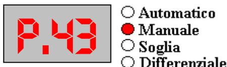
in questa posizione si decide se **abilitare** o **meno** il funzionamento dell'uscita **G** come allarme per umidità BASSA inserendo **000 per abilitarlo** oppure **001 per disabilitarlo** .
